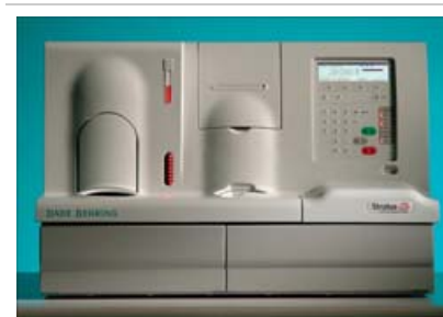
Figure 1. The Siemens Stratus CS mini lab analyser for cardiac markers.
